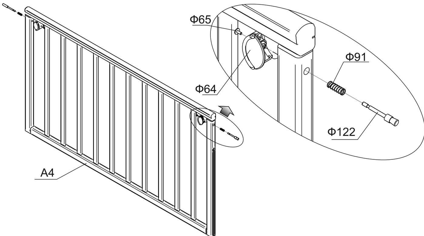
Перед установкой подвижного ограждения A4 ослабить винты на ложе A5 и на ограждении неподвижном A3.
