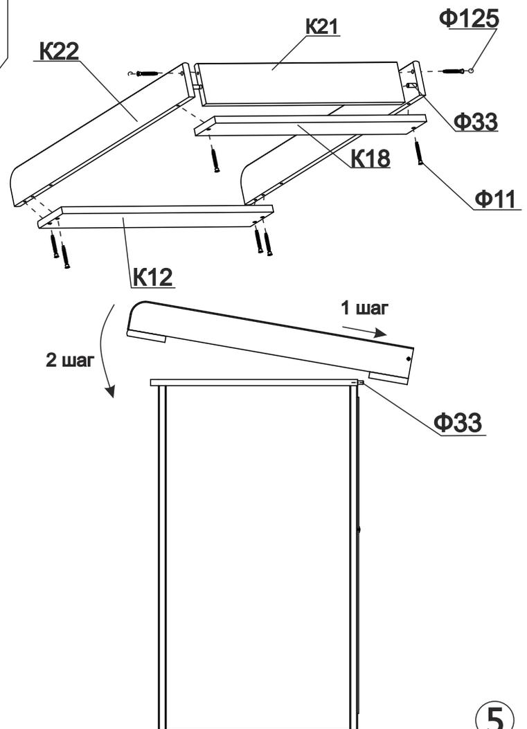
Диагонали полученного короба должны быть равны (проверить рулеткой или шнуром), после этого установить заднюю стенку.
