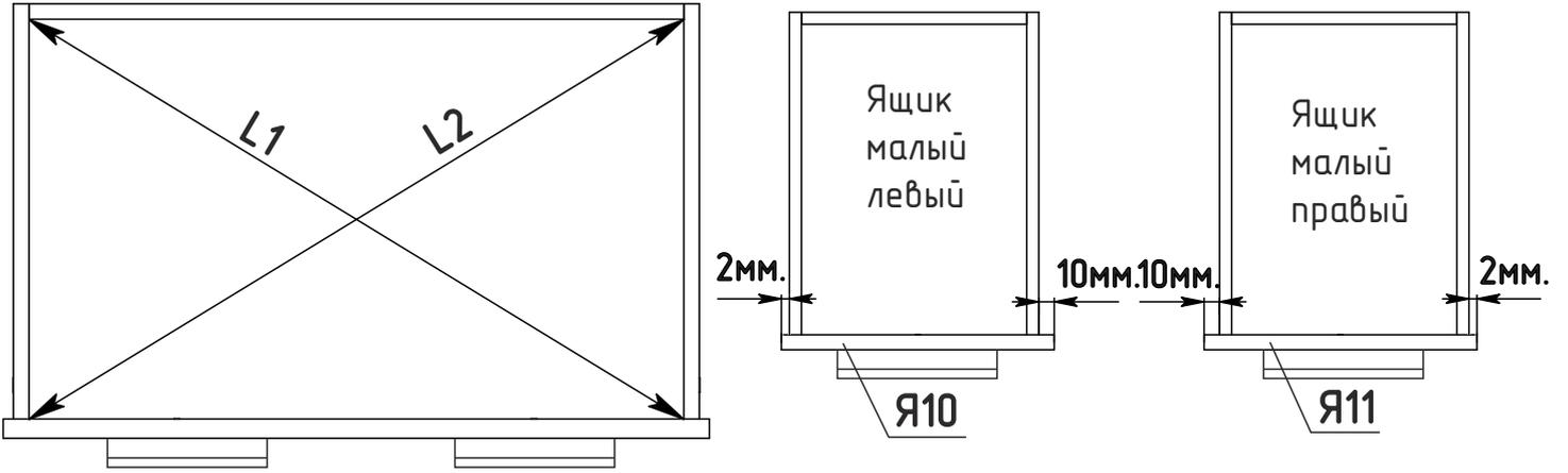
Перед установкой ящиков следует при помощи шнура или рулетки проверить их диагонали. Диагонали должны совпадать ( $L_1=L_2$ ).
