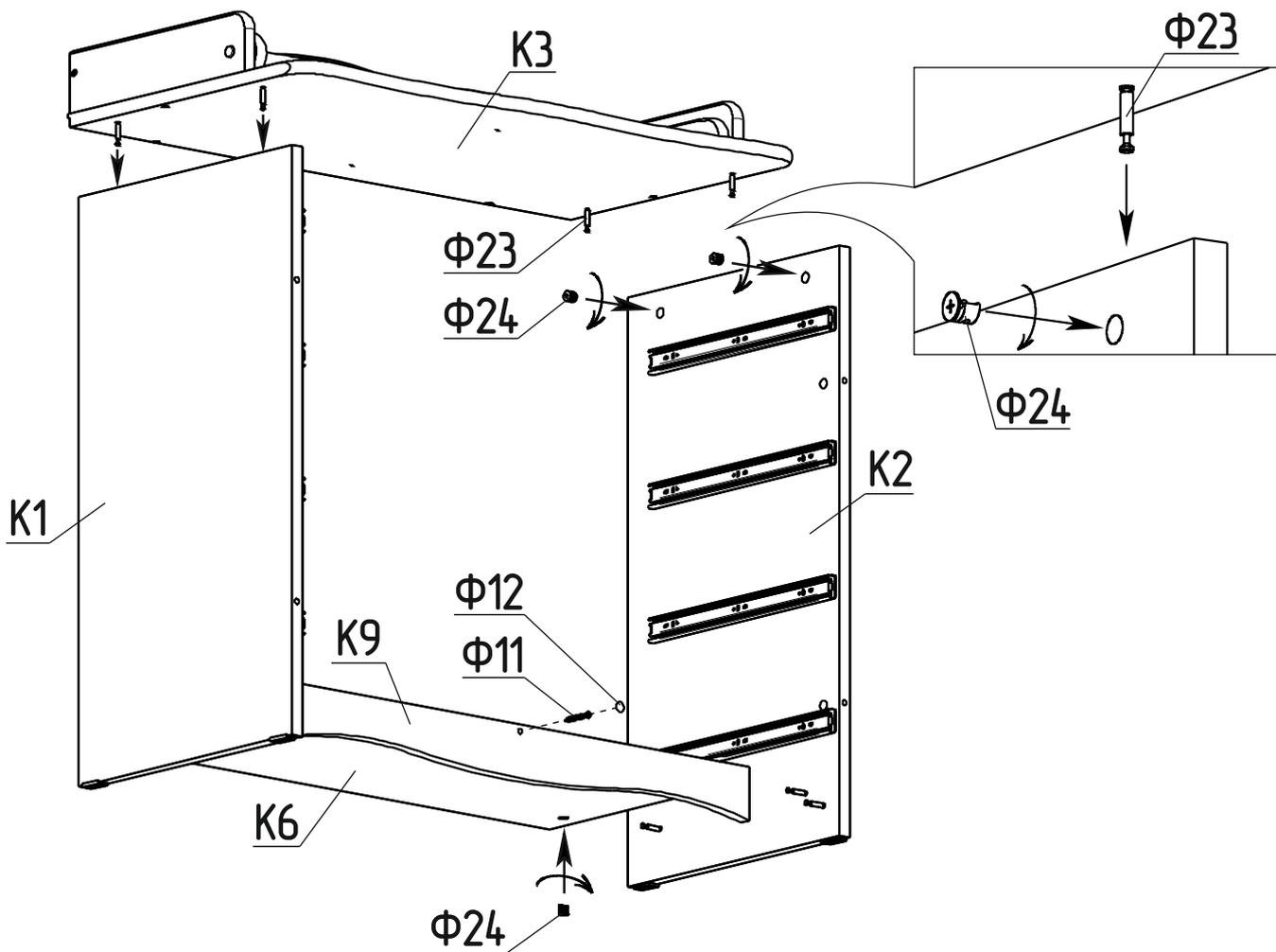
Перед установкой задней стенки следует при помощи рулетки или шнура проверить диагонали полученного каркаса. Диагонали должны быть равны ( $L1=L2$ ).
